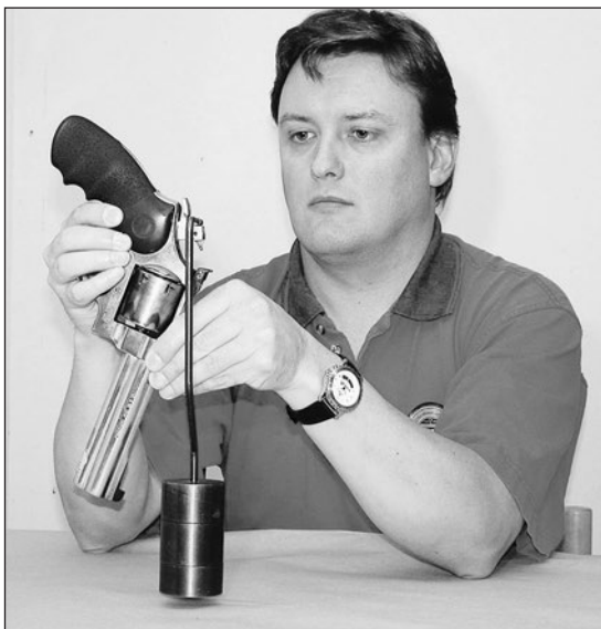
Bild 5: Kontroll av upphakningsmotstånd.
